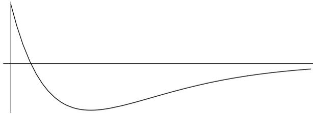
Abbildung 2: Aperiodischer Grenzfall:  $y(t) = (1 - 3t)e^{-t}$
