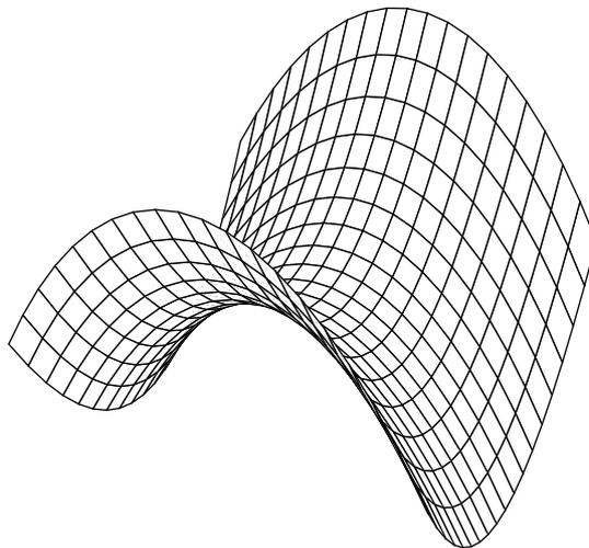
Abbildung 15: Hyperbolisches Paraboloid  $z = \frac{y^2}{\beta^2} - \frac{x^2}{\alpha^2}$
